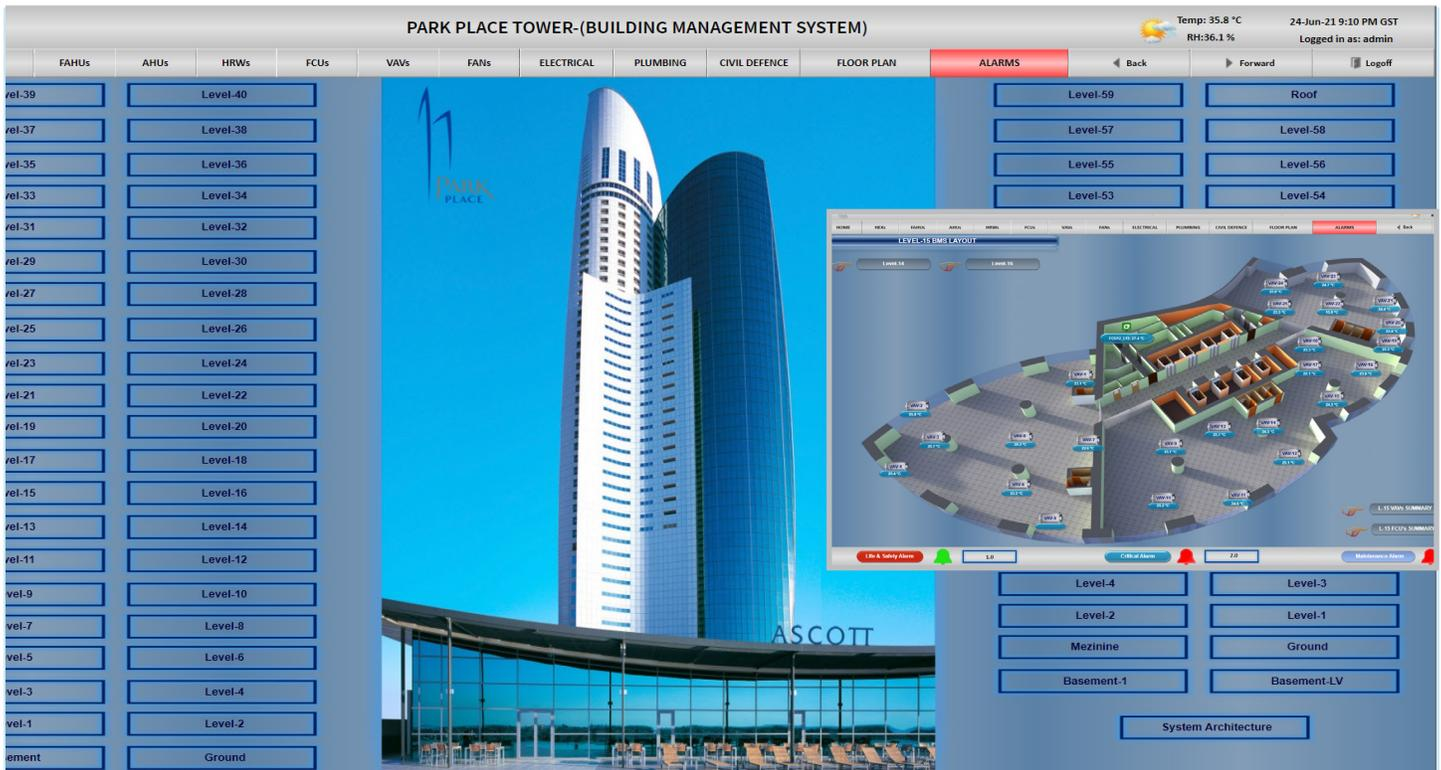
Die kundenspezifische Benutzeroberfläche für den Park Place Tower unterstützt ein grafisches Navigationssystem, mit dem das Gebäudemanagementteam den Status der Gebäudetechnik auf Gebäude-, Etagen-, Geräte- und VAV-Ebene einfach visualisieren kann. So lässt sich die Ursache von Alarmen leicht ermitteln und die Reaktionszeit verkürzt. Das Gebäudeteam ist in der Lage, Trends zu überwachen und Probleme anzugehen, bevor Komfort oder Energieverbrauch beeinträchtigt werden.
